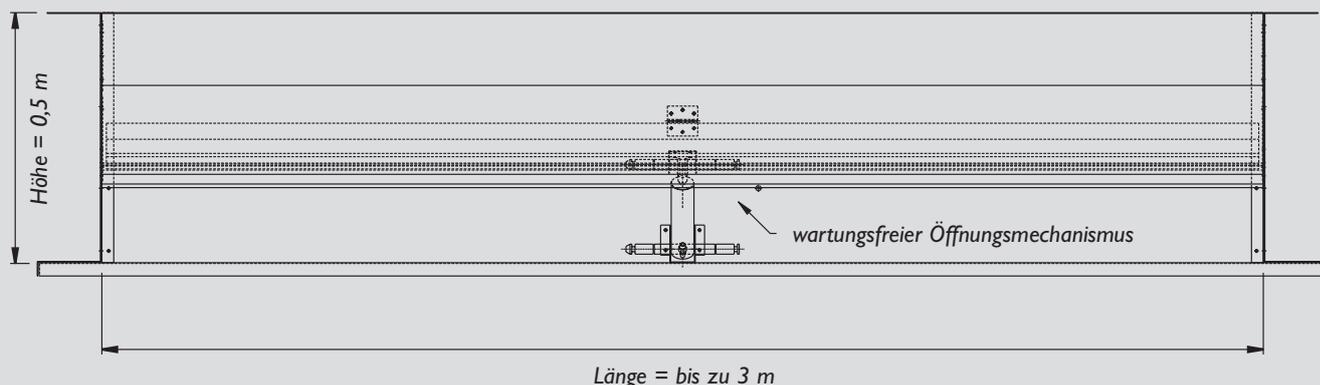
Länge und Breite sind variabel an die Lüftungs-/RWA-Einheit anpassbar, die auf den Weatherlite aufgesetzt wird.
